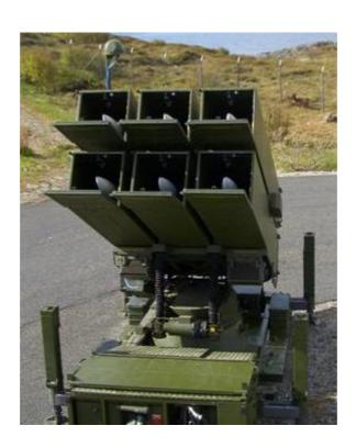
Il NASAMS ( National Advanced Surface to Air Missile System ) è un sistema di difesa aerea a corto e medio raggio distribuito e collegato in rete [5].: 4 sviluppato da Kongsberg Defense & Aerospace (KDA) e Raytheon . [6] Il sistema difende da veicoli aerei senza pilota (UAV), elicotteri, missili da crociera , veicoli aerei da combattimento senza pilota (UCAV) e aerei.
