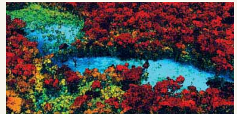
Fig. 29: Le misurazioni laser – LIDAR calcolano la biomassa forestale, creando un profilo tridimensionale della foresta dettagliato al singolo albero (The Carnegie Institution for Science and WWF, in collaborazione con il Ministero dell'Ambiente peruviano)
