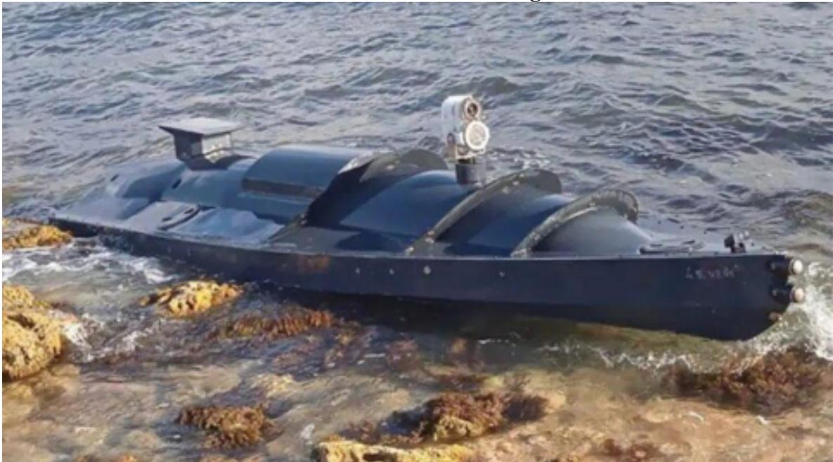
(USV), o colloquialmente navi drone, sono barche o navi che operano sulla superficie dell'acqua senza equipaggio. Gli USV operano con vari livelli di autonomia, dal semplice telecomando alla navigazione autonoma.
