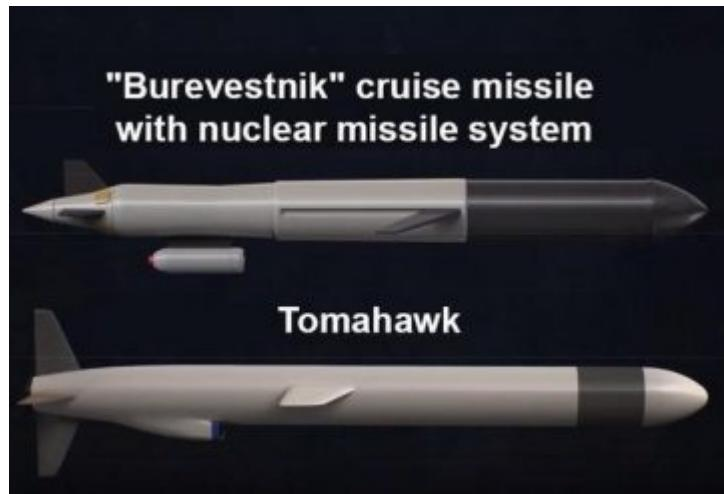
L'ipotesi più probabile è che però si sia optato per il ramjet, anziché un turbogetto, perché se già esiste un primo stadio booster che accelera il missile, la presenza di compressore e turbina sarebbe una complicazione meccanica inutile e perniciosa in termini di peso.
