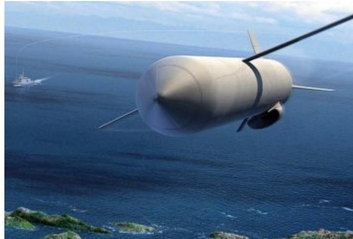
Già nel 2019 il professore americano Jeff Terry, dell'Istituto di Tecnologia dell'Illinois, aveva calcolato la potenza del reattore del Burevestnik attorno ai 766 KiloWatt, equivalenti a circa 1.027 cavalli, forza bastante a far volare un oggetto del peso e dell'ingombro simile a velocità subsoniche a bassa quota.
